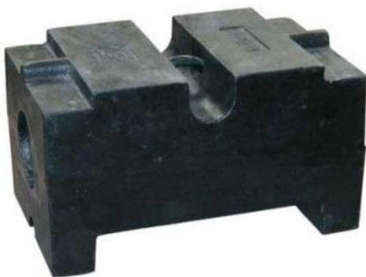
Гири класса точности М1 предназначены для поверки и калибровки весов среднего (III) класса точности по ГОСТ OIML R 111-1-2009 в соответствии с нормативными документами по поверке, для калибровки (юстировки) электронных весов, а также для взвешивания веществ и материалов.
